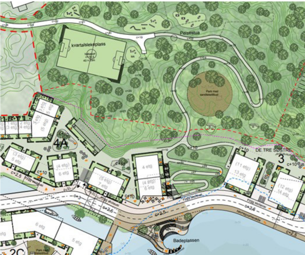
Eksempel på illustrasjonsplan for Kanalbyen og Peisestua med tilstrekkelig høydesetting. Enkelte prinsipper i illustrasjonsplanen er bundet i bestemmelser til planen. Infrastruktur i grunnen er godt samordna med planen og vist i eget kartlag. Tegning A-lab/Rambøll
